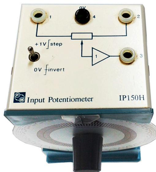
Figura 1.5: Módulo IP150H: potenciômetro de ajuste.
