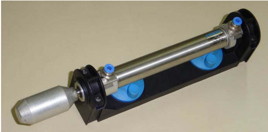
Figura 7 – Cilindro de dupla ação
