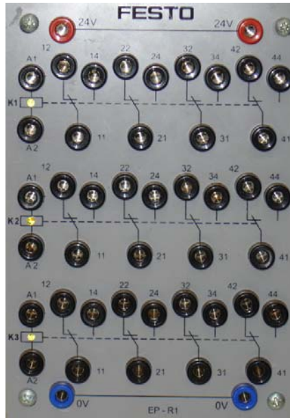
Figura 52 – Uma caixa com três relês, cada um possuindo quatro contatos, que podem ser fechados ou abertos
