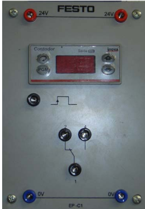
Figura 69 – Contador digital da Festo
