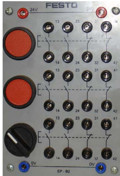
Figura 53 – Uma caixa com três botões, um trava e dois pulso (vermelhos), cada um com quatro contatos, 2NA e 2NF
