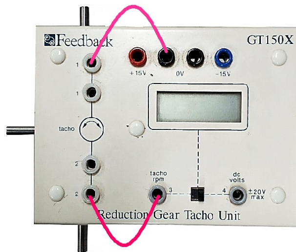
Figura 5.11: Conexão sugerida para o tacho-gerador.
