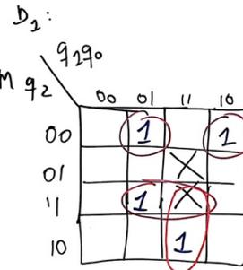
$$D_1 = \bar{M} \cdot \bar{q}_2 \cdot \bar{q}_1 \cdot q_0 + \bar{M} \cdot \bar{q}_2 \cdot q_1 \cdot \bar{q}_0 + M \cdot q_2 \cdot q_0 + M \cdot q_1 \cdot q_0$$
