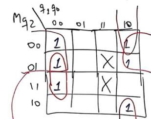
$$D_0 = \bar{M} \cdot \bar{q}_0 + q_2 \cdot q_1 \cdot \bar{q}_0 + q_2 \cdot \bar{q}_1 \cdot \bar{q}_0$$
