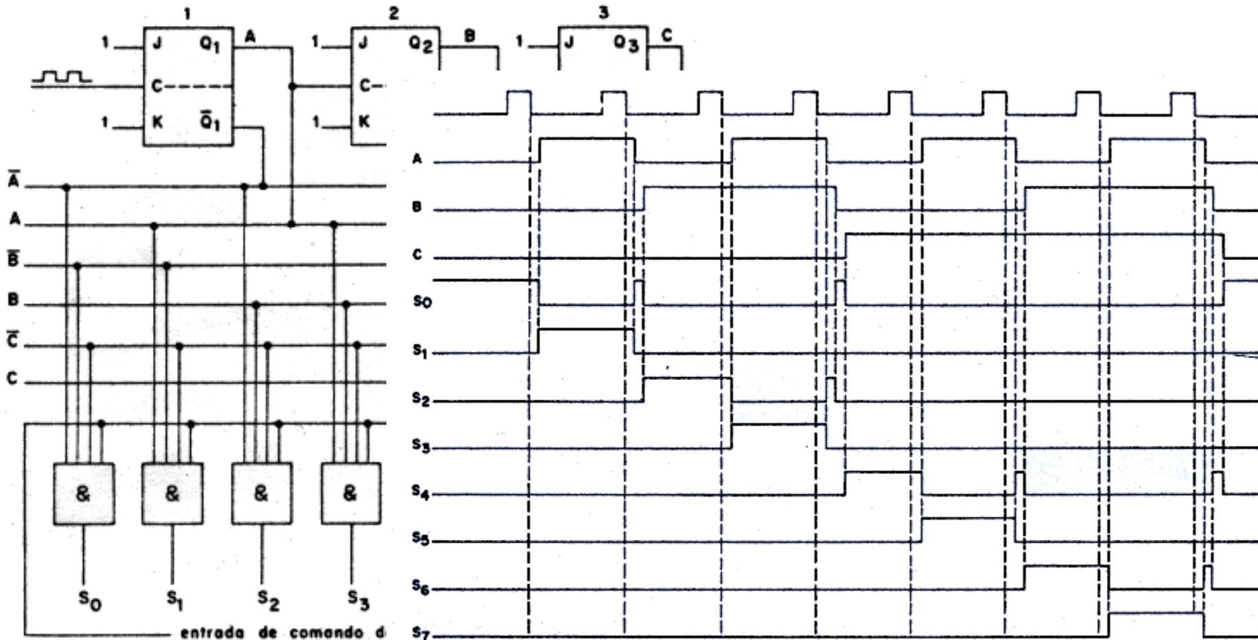
Figura acima: circuito de contador assíncrono com saídas decodificadas.
