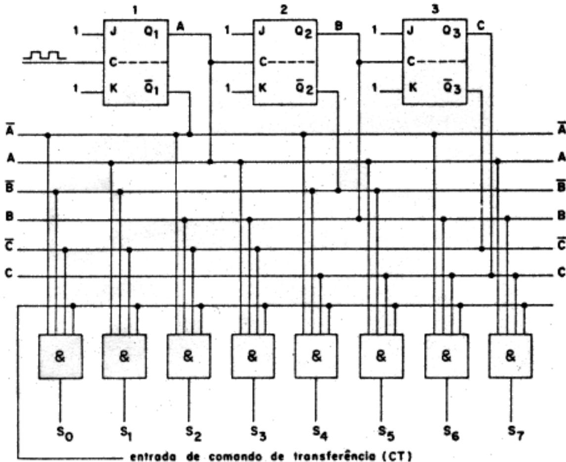
Figura acima: circuito de contador assíncrono com saídas decodificadas.
