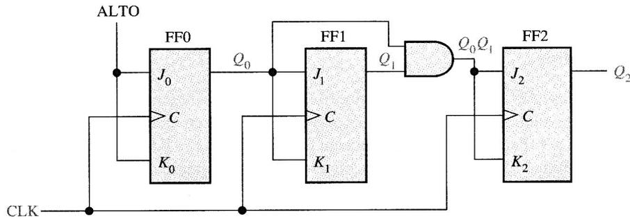
FIGURA 8.14 Contador binario síncrono de 3 bits.
