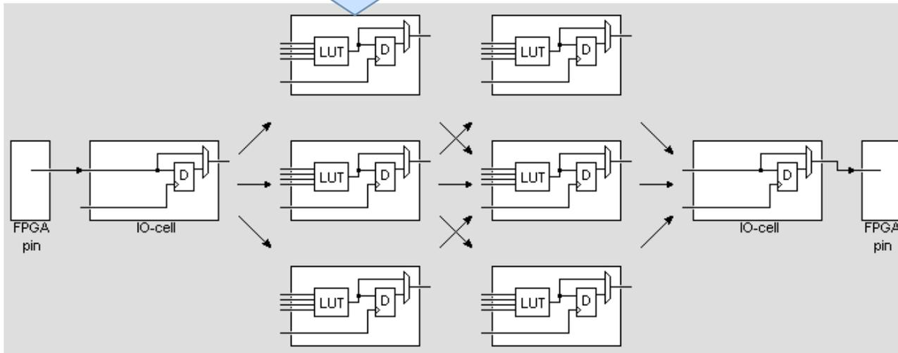
Uma pastilha FPGA é formada por centenas ou milhares destas células lógicas básicas. Cada célula lógica pode ser conectada a outras células através de recursos de interconexão ("fusíveis") programados por software. Cada célula isoladamente pode fazer pouco, mas com muitas delas conectados juntas, funções lógicas complexas podem ser criadas através de células de Entrada/Saída (IO-cells).
