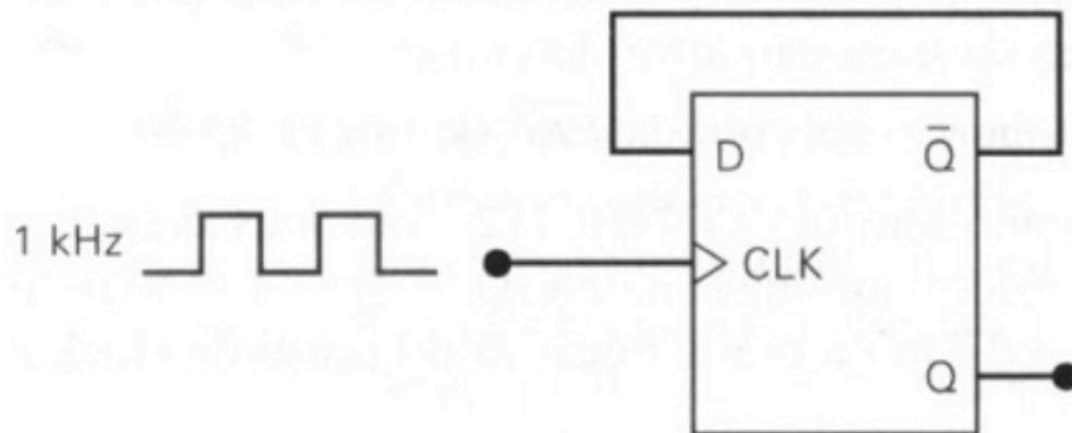
**FIGURA 5.67** Flip-flop D configurado como um FF tipo T (Problemas 5-15 e 5-16).
