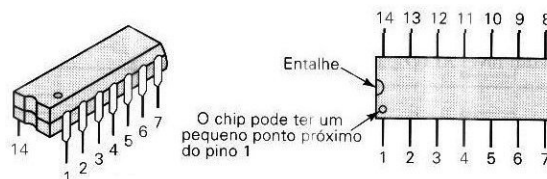
Figura 1.1: Encapsulamento DIP e numeração dos pinos.
