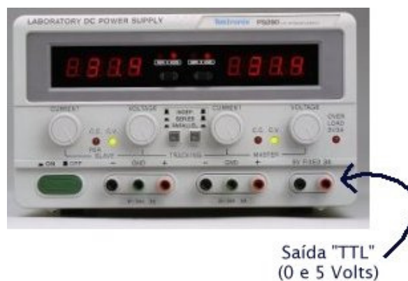
Figura C.2: Destacando a saída "TTL" numa fonte de alimentação.
