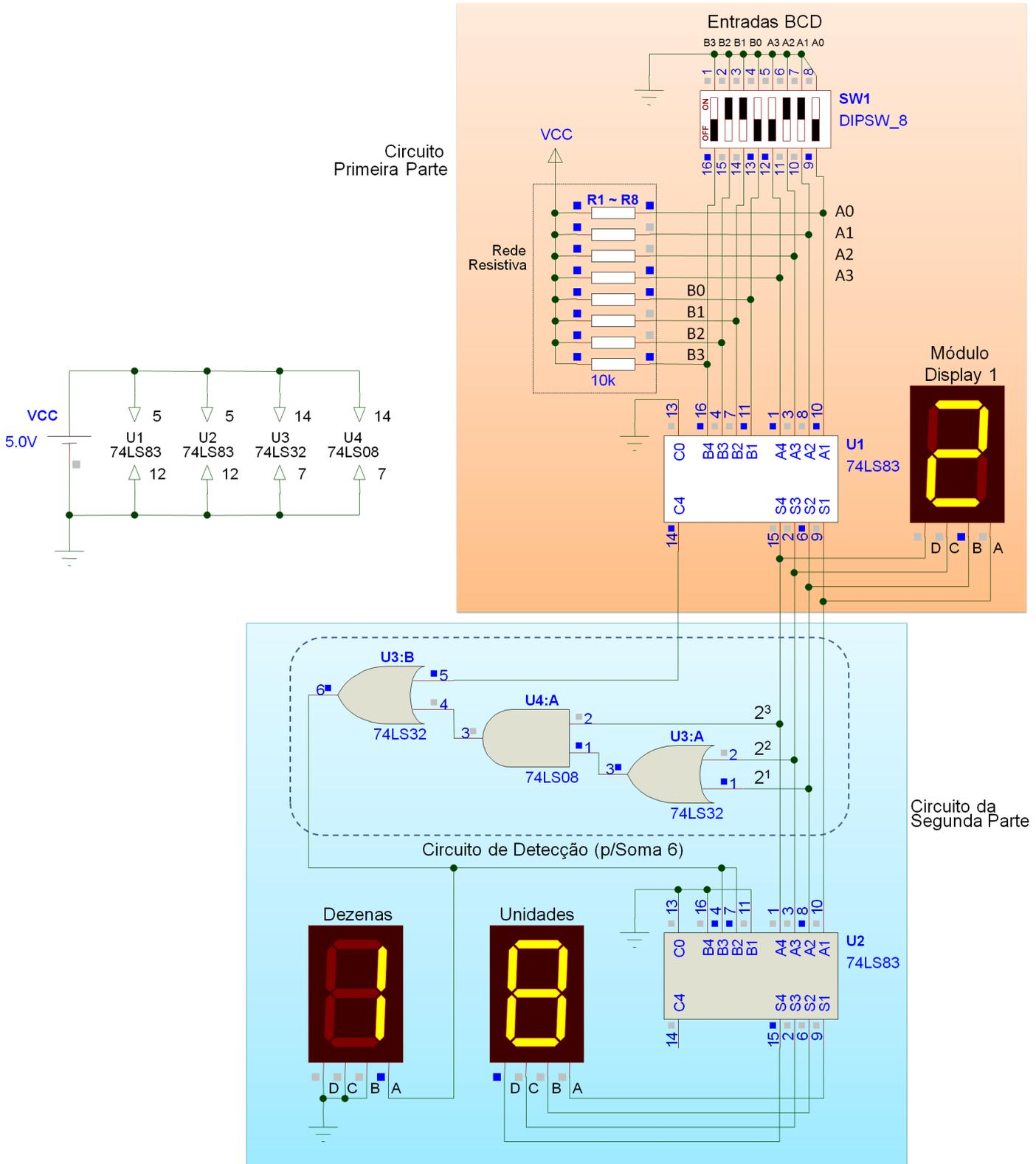
Figura 1: Montagem prevista para este laboratório.
