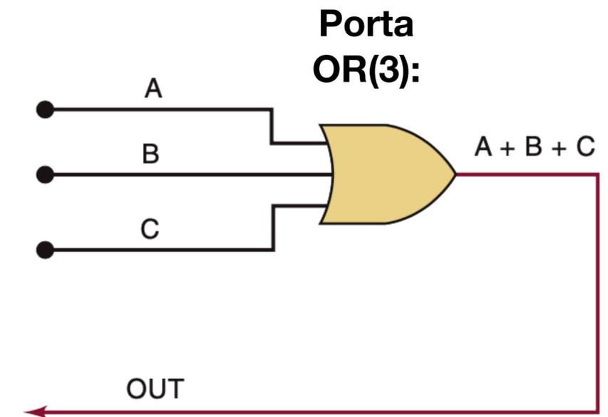
**Note: basta uma entrada em nível lógico ALTO para saída comutar para nível lógico ALTO:**
