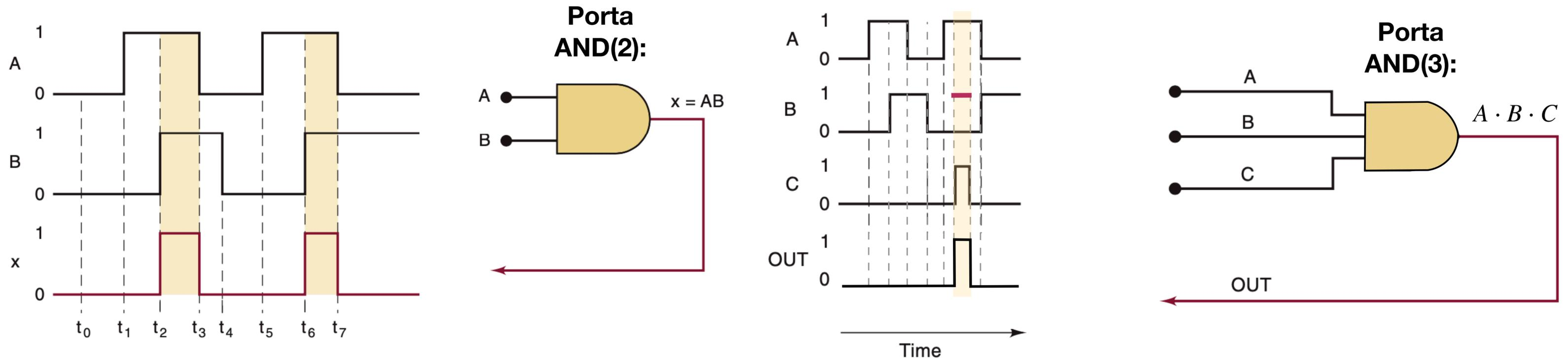
**Note: TODAS as entradas devem estar em nível lógico ALTO para saída comutar para nível lógico ALTO:**
