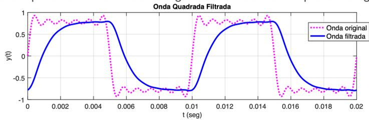
Atenção: as figuras ao lado mostram o caso de uma onda quadrada oscilando à 100 Hz (sintetizada até sua 11ª-harmônica), sobre a qual foi aplicado um filtro passa-baixas com frequência de corte em 300 Hz.
