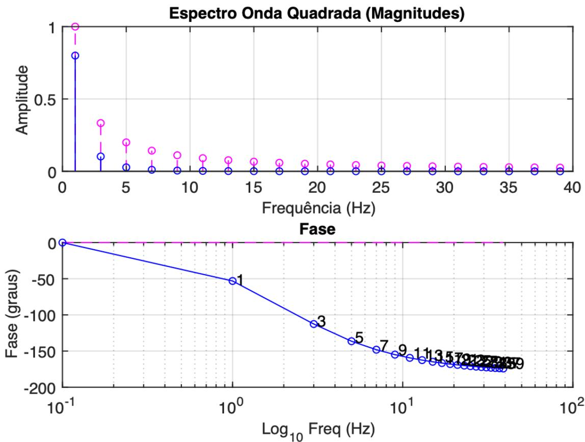
Os diagramas espectrais ajudam a entender de que forma as componentes originais da onda quadrada foram afetadas pelo filtro passa-baixas.
