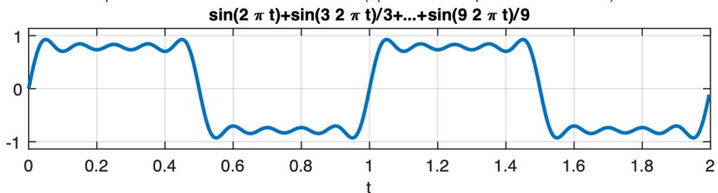
Note que a onda quadrada pode ser sintetizada à partir de uma equação como:
